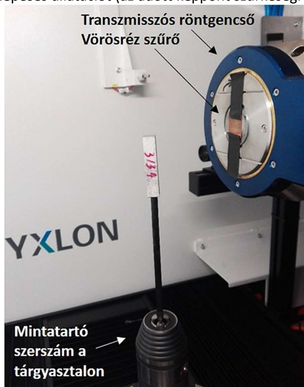
3. ábra.: A 10x10x50 mm-es próbatest mérési pozíciója az YXLON FF35 röntgenberendezésben
